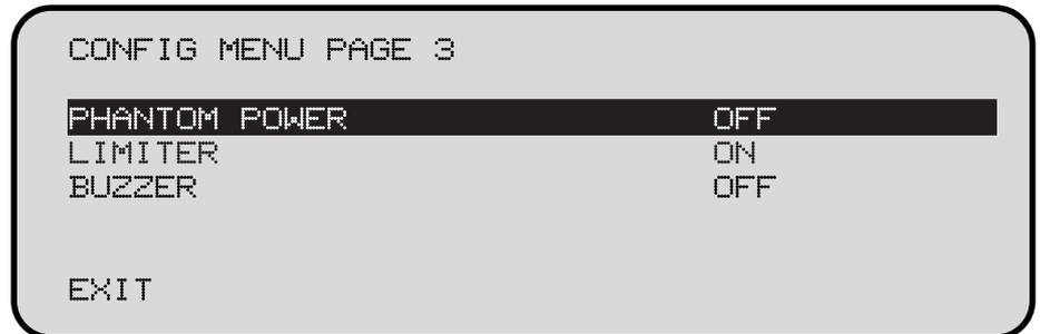
**PHANTOM POWER:** Schaltet die Phantomspannung der Mikrophoneingänge ein oder aus.
